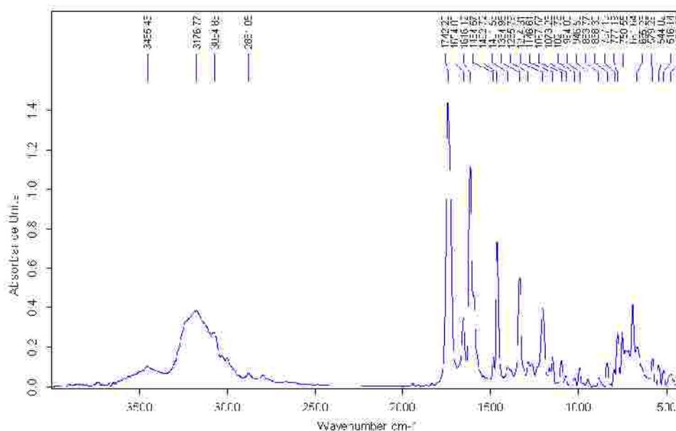
**Figure II.3.** IR spectrum of aniline-isatin (L<sup>1</sup>), a Schiff-base type ligand
