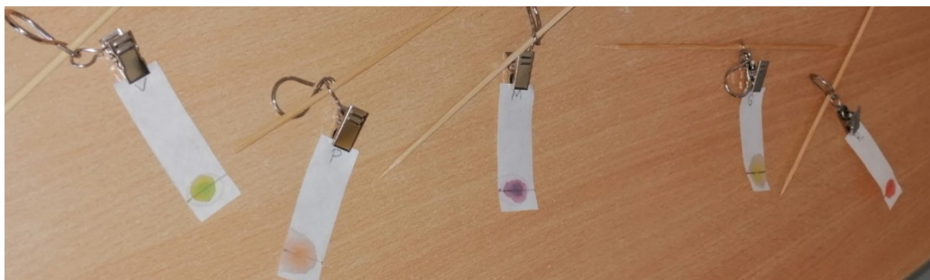
Figura 4. Hârtia cu soluția aplicată pe linia bazei.
