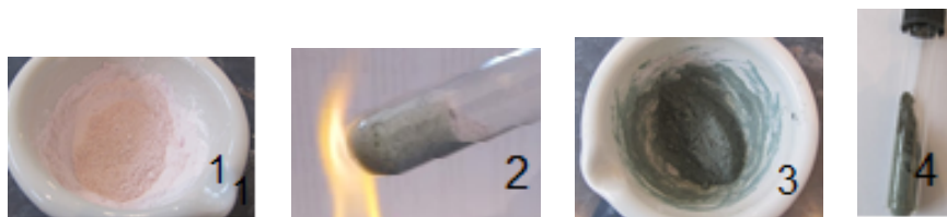
Figura 7. Obținerea verdei de cobalt în laborator: 1 – amestec de \text{CoCl}_2 și \text{ZnO} mojarat; 2 – pigment în curs de formare; 3, 4 – pigmentul obținut, mojarat.
