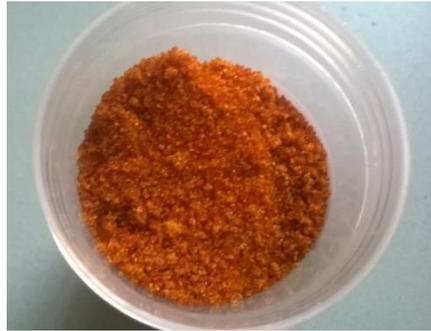
Gel PIM sub forma de fractii granulometrice: a) fractia 1...3 mm; b) fractia mai mica de 1 mm.
