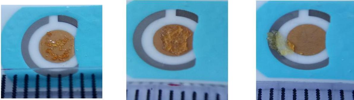
Efectul imersarii in solutie de tampon asupra MIP-ului imobilizat in PVA-Sbq pe electrod screen-printat din aur. Stanga electrod imediat dupa imobilizare. Mijloc electrodul dupa 30 min de imersare se observa o umflare a stratului imobilizat. Dreapta dupa inca 30 de minute stratul imobilizat este complet dezlipit de pe electrod.
